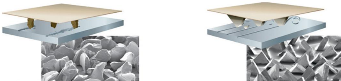
Рис. 2. Обычное абразивное зерно, имеющего неправильную форму (слева); зерно Cubitron ПМ, покрытое керамикой (справа)
