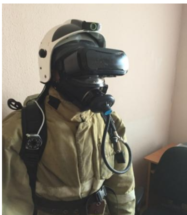
Рис. 2. Устройство видеовывода информации
