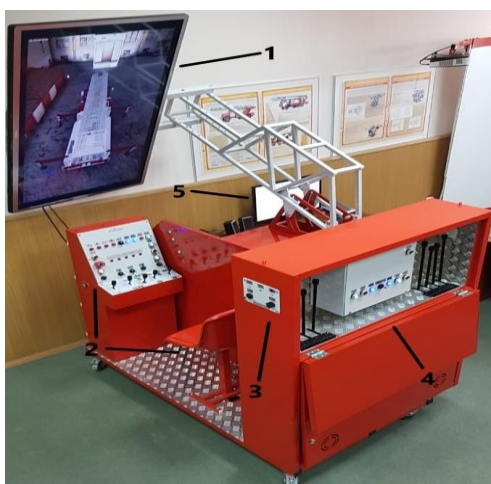
Рис. 1. Общий вид тренажера: 1 – экран; 2 – рабочее место оператора (пульт управления пакетом лестниц); 3 – панель управления коробкой отбора мощности; 4 – отсек управления гидравлическим насосом и аутригерами; 5 – рабочее место преподавателя
