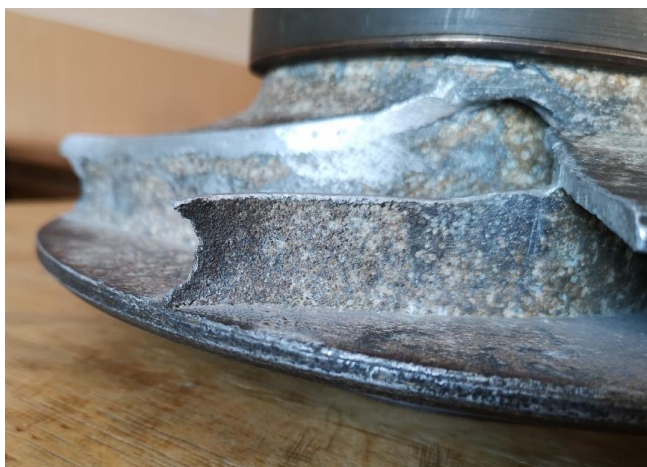
Рис. 1. Износ крыльчатки рабочего колеса насоса
