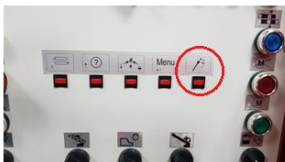
Рис. 3. Панель управления с места оператора на «подвижной части» автолестницы
